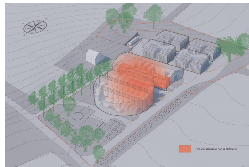
Schéma de principe mettant en évidence la chaleur produite par le process des alambics
